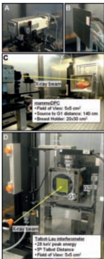
Abb. 1. Die Untersuchungseinheit mammoDPC. (A) Seifert Röntgenquelle. (B) Hamamatsu Flat Panel CMOS-Detector mit 2400x2400 pixels, 50x50 Micrometer. (C) mammoDPC System, Probenhalter mit Brust auf der rechten Seite. (D) Talbot-Lau Interferometer.
